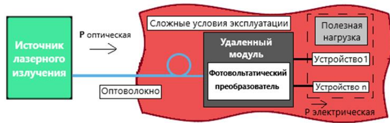
Рисунок 1 – Структурная схема системы PoF
