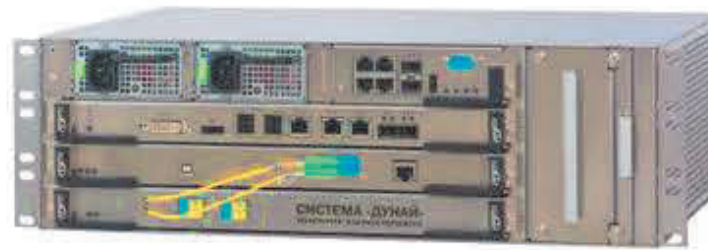
Пример распределенного акустического сенсора «Дунай» (ООО «Т8»)
