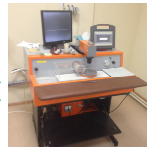
Алмазная резка (разделение на чипы)
