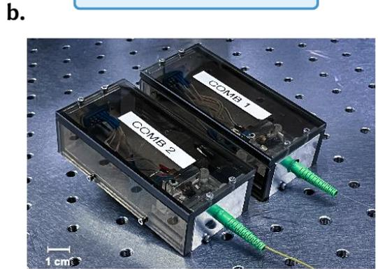
Создан прототип с шириной спектра 400 нм и рекордной эффективностью преобразования накачки (~40%)
